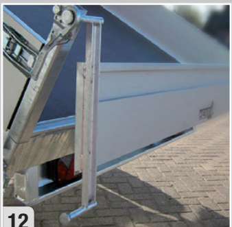
12 Bovenscharnierend achterbord (optie) Ridelle arrière articulant en haut et en bas (option)
