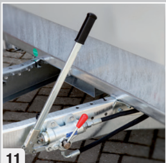
11 Noodhandpomp (optie) Pompe de secours manuelle (option)
