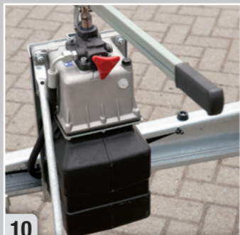
10 Handpomp op dissel Pompe manuelle à la flèche
