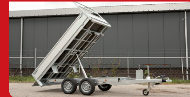
5-traps, zeer sterke cilinder, met 48° kiphoek (geschikt tot 6100 kg) Vérin très puissant (5 cylindres) inclinaison 48° (force de traction 6100 kg).
