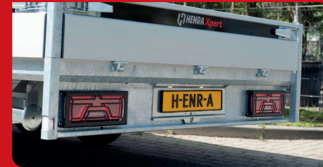
Dynamic LED achterlichten, met achterlichtbeschermers zwart gecoat, Xpert uitvoering. Feux arrière dynamiques à LED, avec protections des feux arrière, revêtement noir, version Xpert.
